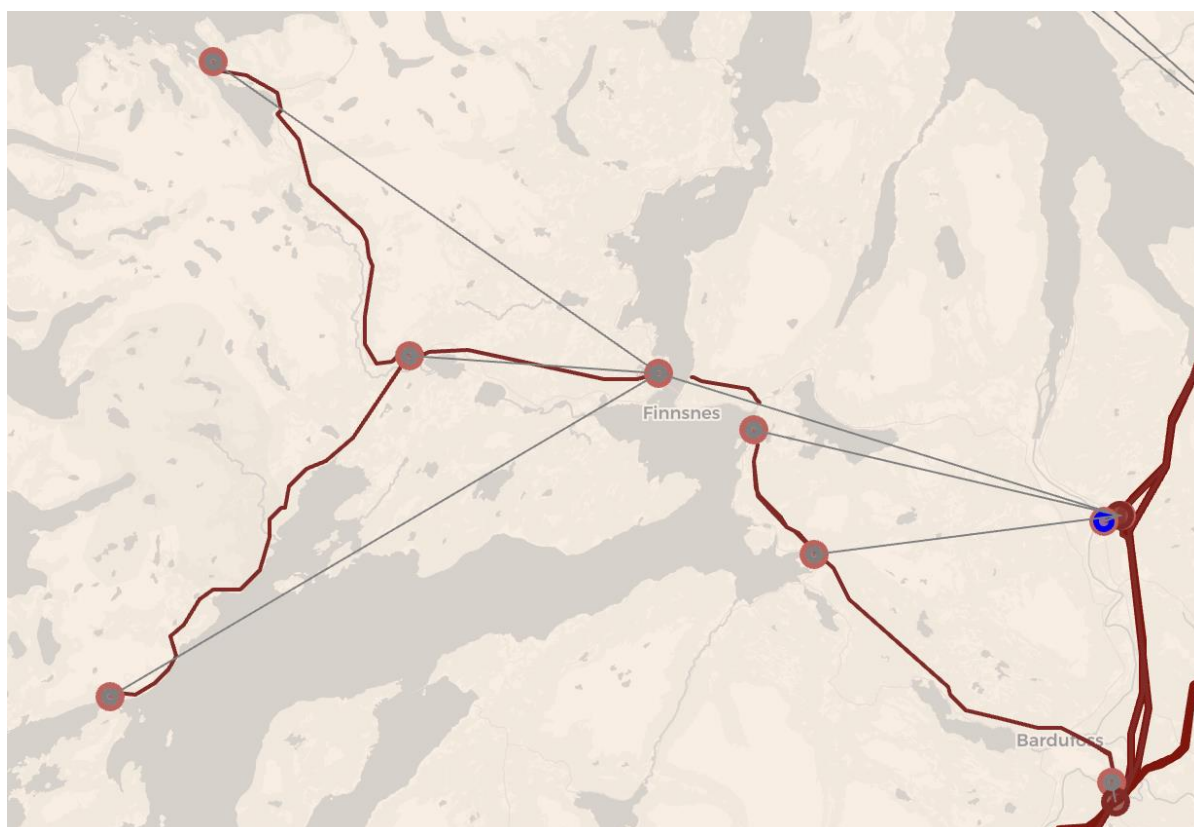
Figur 14-2: Koblinger mellom trafoer.
