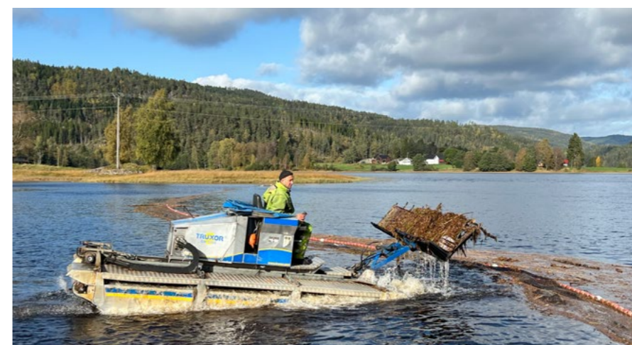
Fjerning av krypsiv ved oppsamlingslensen for transport til deponi.
