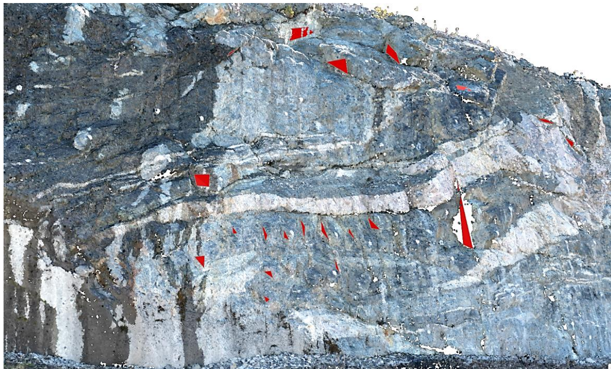
Figur 2-7. Eksempel på digitaliserte plan fra dronepunktsky. Røde plan gir fall og fallvinkel på sprekkeflatene. Utsnittet er fra skjæringen ned til E6 noe sør for selve rasområdet.
