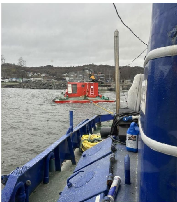
Figur 2-8: Dumpelekter med avstand til taubåt.
