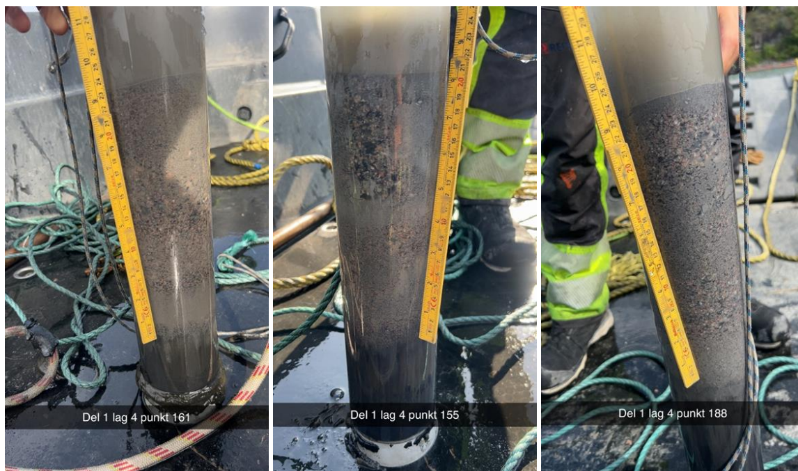
Figur 4-1: Eksempel på utført kjerneprøver ferdig tildekkingslag.
