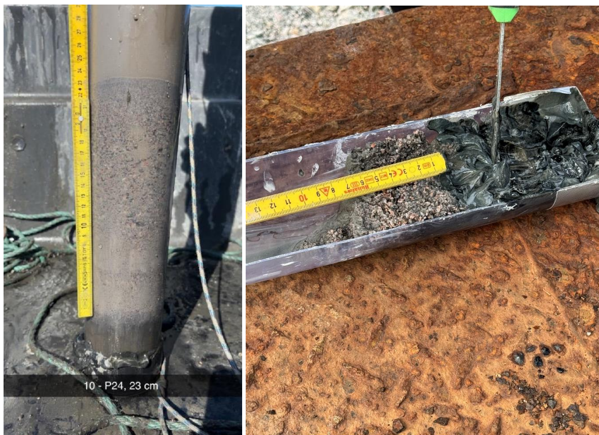
Figur 8-9: Kjerneprøve og kjerneprøve som er splittet opp
