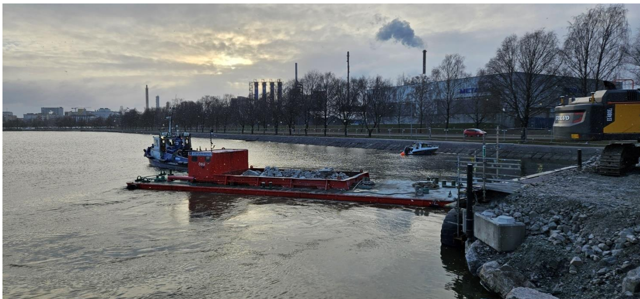
Figur 8-1: Dumpelekter fylt med stein for sjete
