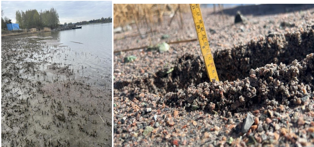
Figur 4-3: Oppmåling av tildekking i strandsoner
