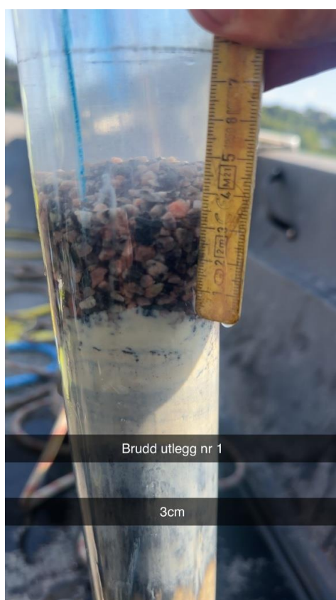
Figur 4-7: Kjerneprøve nr 1 og 10 etter tildekking av innsunket område med 3cm
